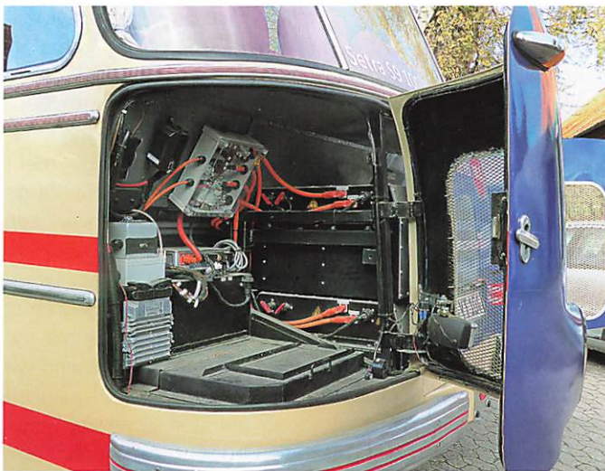
Hier befindet sich das Herz des elektrischen Antriebs, die Verteilerbox und ein Inverter. Klappt man die untere Abdeckung auf, hat man einen Zugang zu den 12VoltBatterien, die Energie für die Nebenaggregate wie Scheibenwischer und Innenbeleuchtung liefern.
