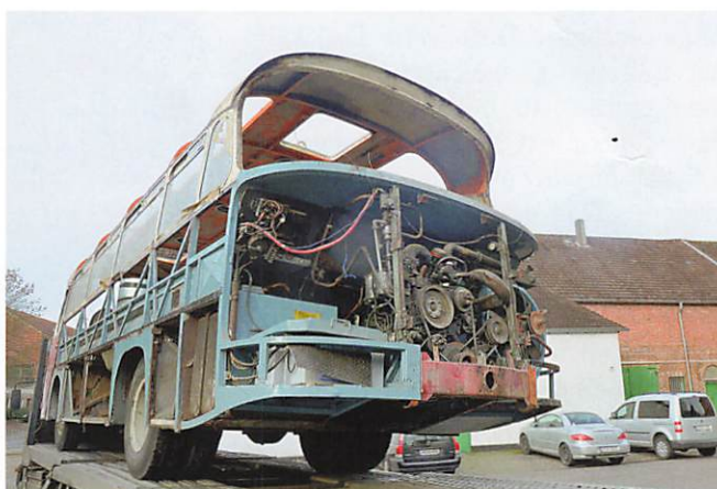
Der ursprüngliche Henschel Reihensechszylinder war nicht mehr zu verwenden. Bevor sich Krüger für die Elektro-Umrüstung entschied, sollte der S 9 einen Mercedes-Benz Motor eingebaut bekommen.
