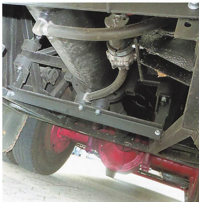
Ein Blick unter den Bus: Der Zentralmotor (schwarzer Zylinder) sitzt hinter der originalen Hinterachse und trifft von hinten auf das Differential. Die Kardanwelle wurde beim Umbau erneuert.
