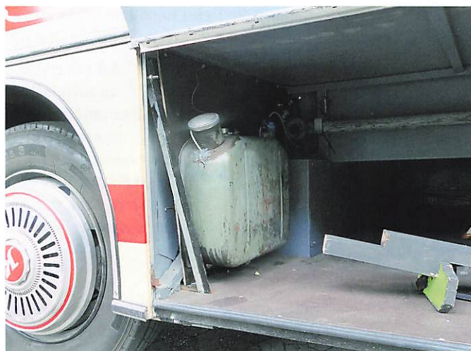
Einen kleinen Dieseltank hat auch der elektrisch angetriebene Setra an Bord, nämlich für die Heizung. Er fasst 15 l.
