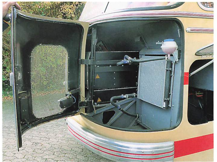
Über die ehemaligen Motorraumklappen gelangt man an die einzelnen Elektrokomponenten, von denen hier der Kühler für das Ladegerät zu sehen ist.
