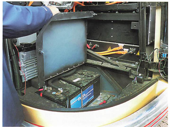
Hier befindet sich das Herz des elektrischen Antriebs, die Verteilerbox und ein Inverter. Klappt man die untere Abdeckung auf, hat man einen Zugang zu den 12VoltBatterien, die Energie für die Nebenaggregate wie Scheibenwischer und Innenbeleuchtung liefern.
