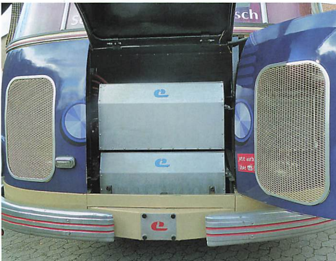
Übereinander mittig platziert sind die beiden Batteriepakete, die eine Kapazität von je 54 kWh aufweisen und vom VW ID 3 stammen. Somit beträgt die Batteriekapazität 108 kWh, womit rund 180 km rein elektrisch gefahren werden können.
