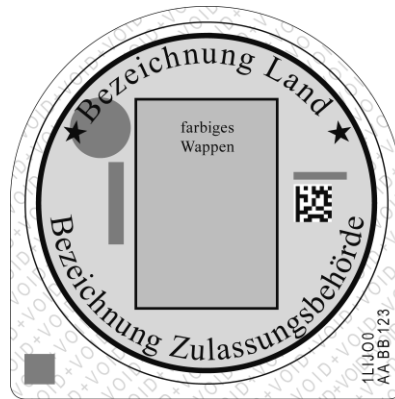
Abbildung 4: Plakettenträger mit Zerstörungsbild
